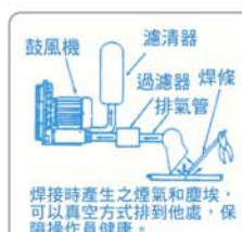
焊接廢氣吸取
